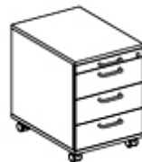
Rollcontainer 8 HE: Höhe 542 mm, Breite 430 mm, Tiefe 600/800 mm
