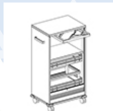
Mobilcontainer: Höhe 1148 mm (3 OH), Breite 600 mm, Tiefe 436 mm, Vertikalrolllade
