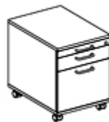
Rollcontainer 9 HE: Höhe 592 mm, Breite 430 mm, Tiefe 600/800 mm
